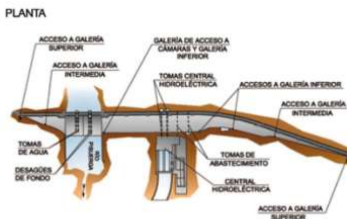
Figura 99. Central hidroeléctrica en la presa del embalse de Aguilar (Fuente: C.H. del Duero)
