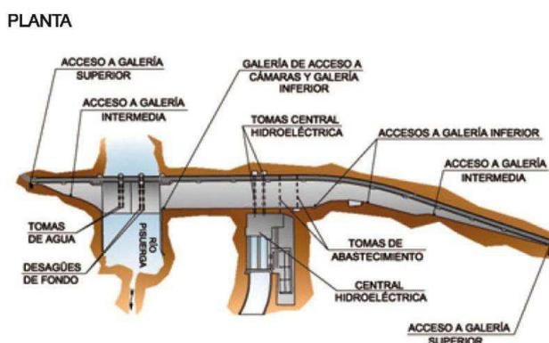
Figura 102. Central hidroeléctrica en la presa del embalse de Aguilar (Fuente: C.H. del Duero)
